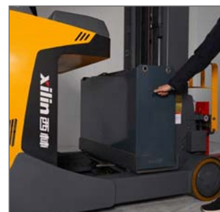
Боковая замена АКБ на роликах - выдвигание вместе с мачтой
