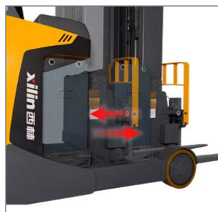
Боковая замена АКБ на роликах - выдвигание вместе с мачтой
